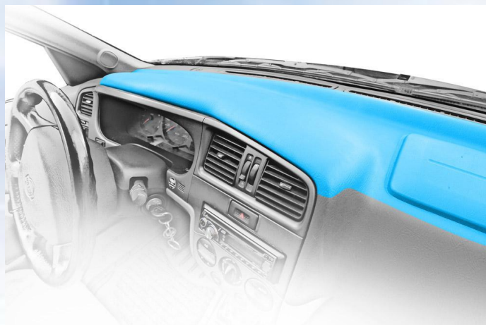
Рис. 9.1 Зона предпочтительного размещения антенн и положение GPSантенны
